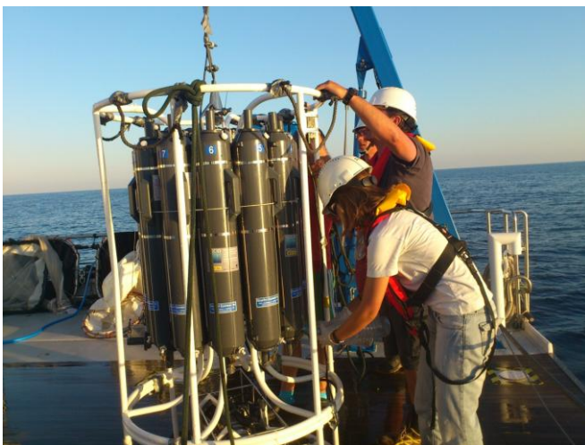
Imagen 3: Operación con roseta oceanográfica y CTD.
