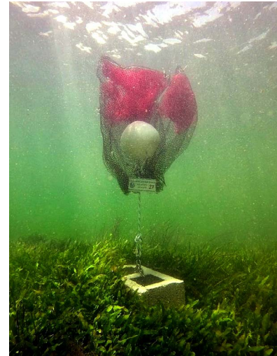
Dispositivo de asentamiento larvario (colector) para juveniles de Pinna nobilis . Colector instalado en Pueblo Cálido (izq) y Perdiguera (dcha).
