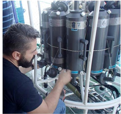
Roseta oceanográfica utilizada para la obtención de perfiles horizontales y la toma de muestras de agua.
