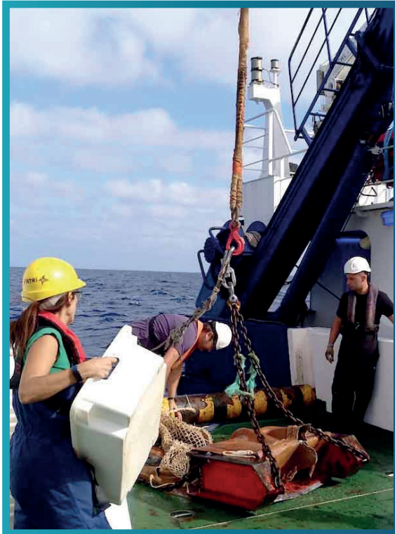
A la izquierda: draga de roca para la toma de muestras de roca y su fauna sésil. A la derecha: trineo fotogramétrico para la toma de imágenes del fondo marino y su flora y fauna bentónica.
