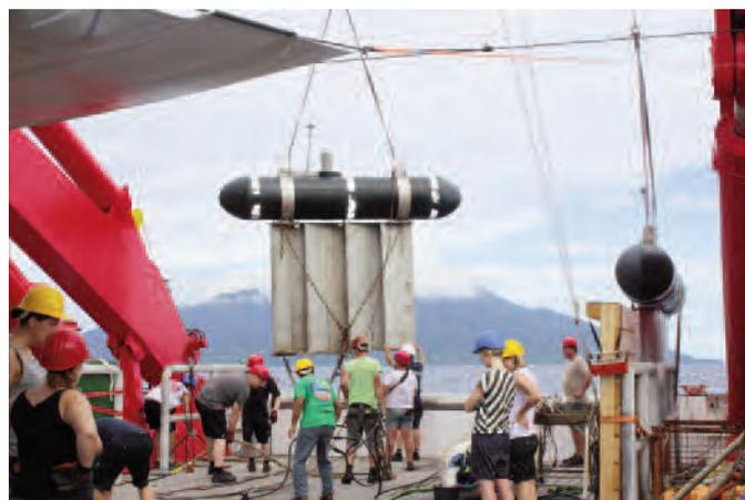
Los técnicos preparan el sistema de prospección sísmica en la cubierta del *Sonne*. Foto: GEOMAR.
