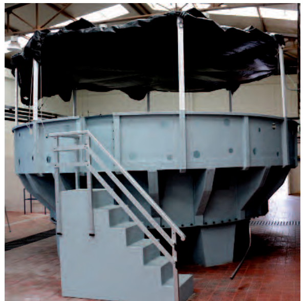
Tanque de cultivo larvario de gran volumen ( 32 m 3 ) utilizado en el cultivo de mero.
