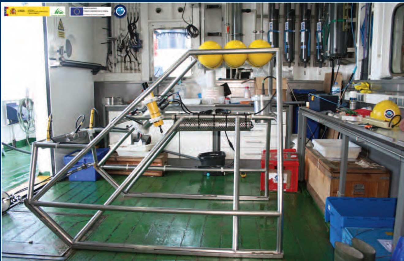
Trineo fotogramétrico usado en la campaña ISUNEPCA_0814.
