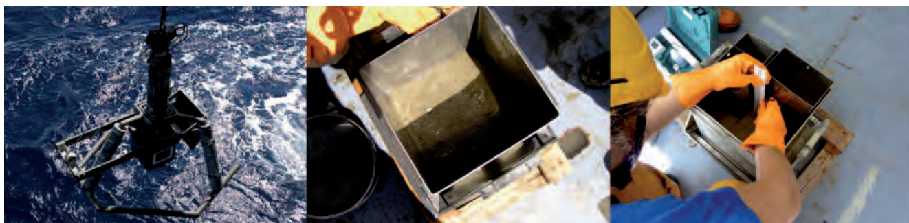
Muestreando el fondo con box-corer. Esta draga es capaz de recuperar varias decenas de centímetros de sedimento manteniendo su estructura, lo que permite conocer sus características y su fauna.
