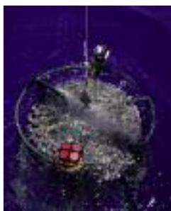
tellas dispuestas en círculo, que van tomando muestras de agua en 24 profundidades, y que además lleva instalada otra serie de instrumentos, encargados de medir distintos parámetros físicos: el CTD y el LADCP.
