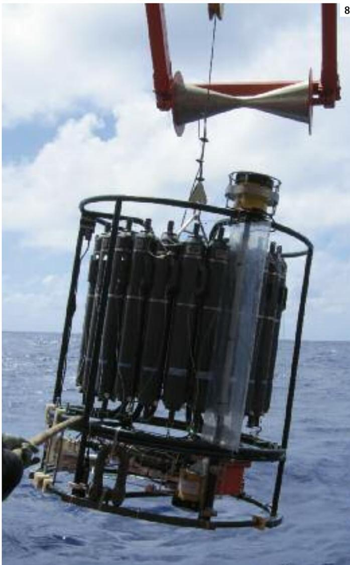
Parte de la información de esas muestras de agua filtrada se analiza en el barco, mediante un fluorímetro, un instrumento que mide la concentración de clorofila. La función de este análisis es contrastar las medidas en continuo de este pigmento obtenidas con el sensor de la roseta.
