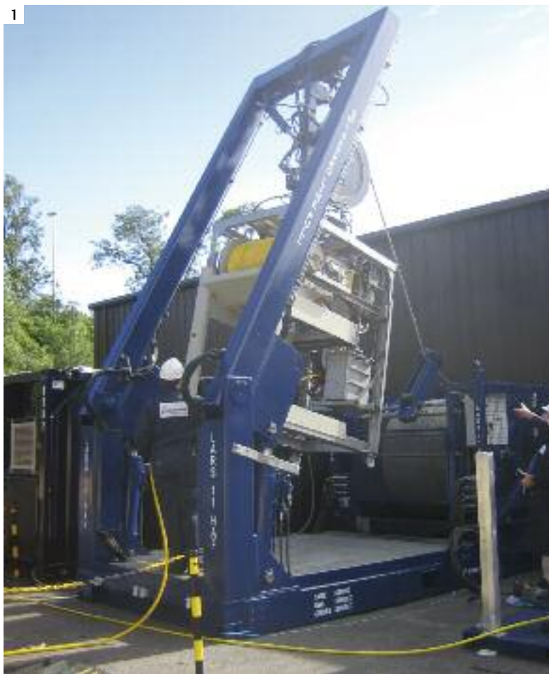
| 1 | Grúa A-frame cargando el ROV en el interior del TMS. | 2 | Comienzo de la inmersión del ROV con el TMS. | 3 | LIROPUS 2000 en su primera inmersión en una piscina para su calibración.
