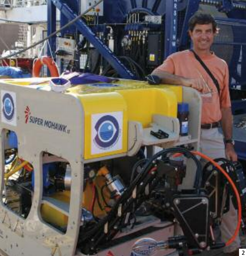
| 2 | Después de una inmersión con el ROV 600 Swordfish durante la campaña TREBOL realizada en 2005 en el B/O Vizconde de Eza. Con este ROV se realizaron las primeras inmersiones científicas hasta 600 m en El Cachucho.
