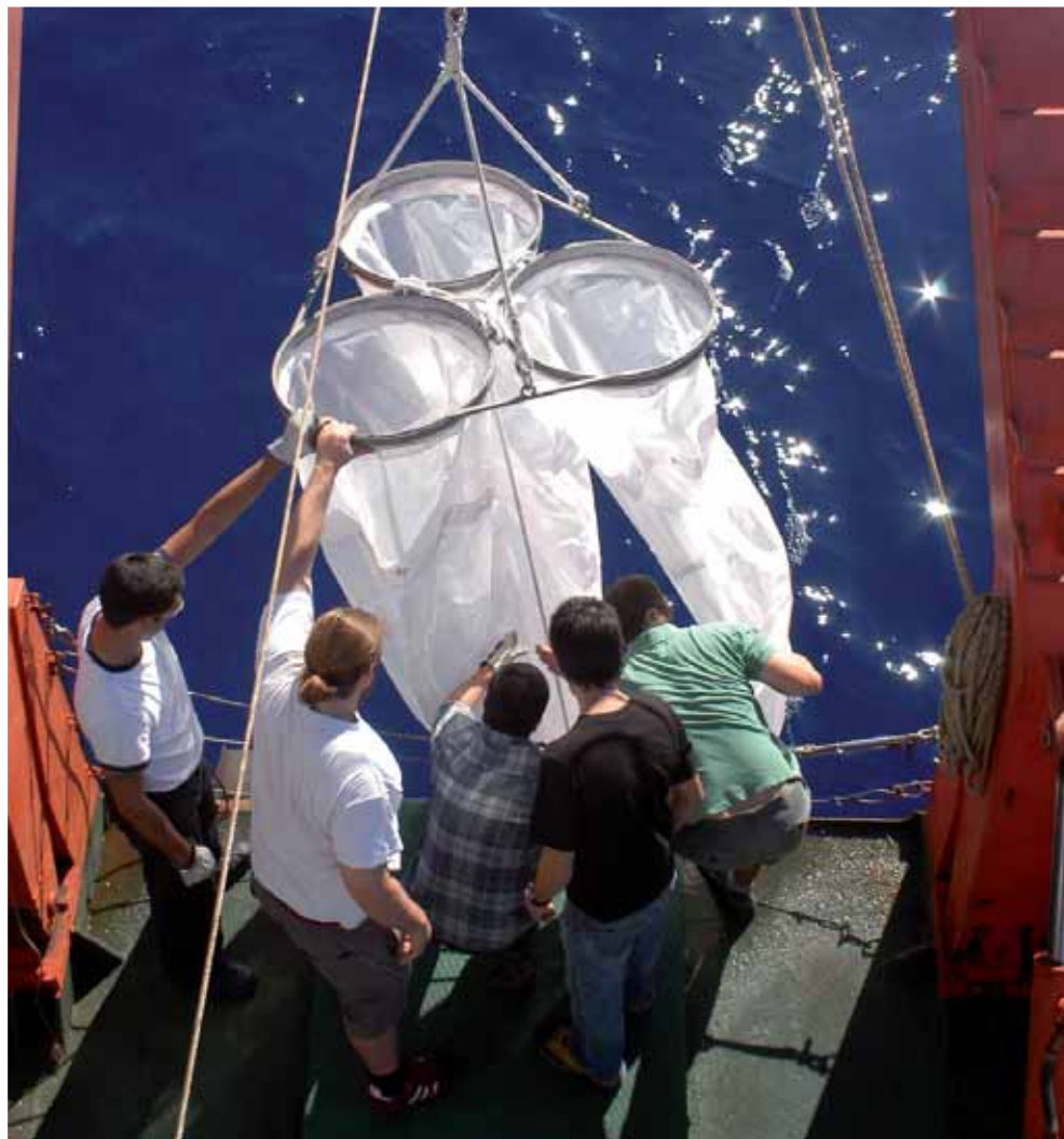
[2] Operación de largado de redes de plancton. Para recoger muestras de plancton oceánico éste debe ser previamente concentrado utilizando distintos tipos de redes. En este caso se usa una red de triple aro que permite recoger tres muestras de forma simultánea en una sola operación de pesca. (Campaña CARPOS-I, BIO Hespérides, 19/09/2006, Foto: A. Bode).
