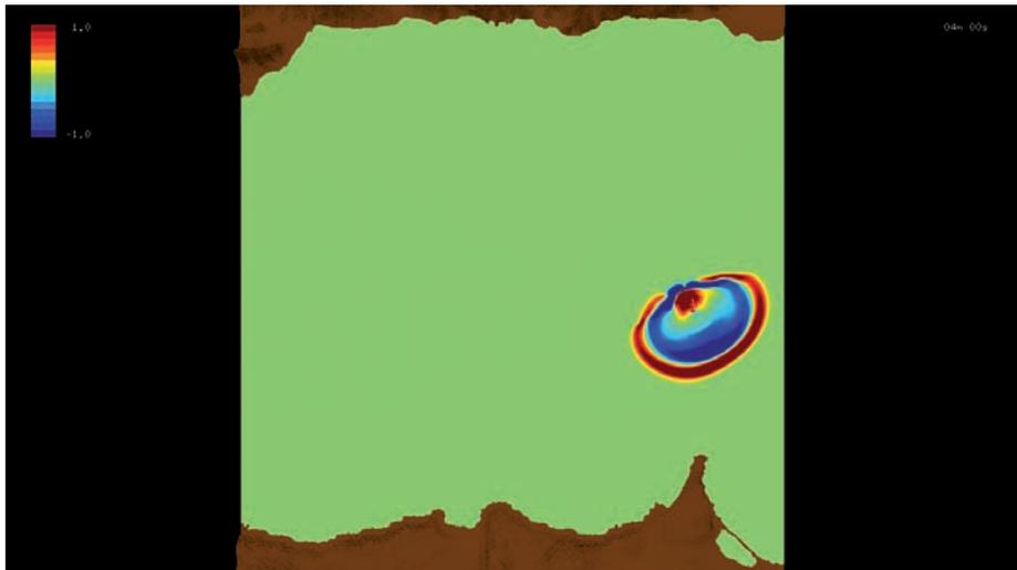
**Figura 4.14.** Instantes iniciales de la propagación de la onda. En azul se representa la onda de depresión y en rojo la onda de sobreelevación.
