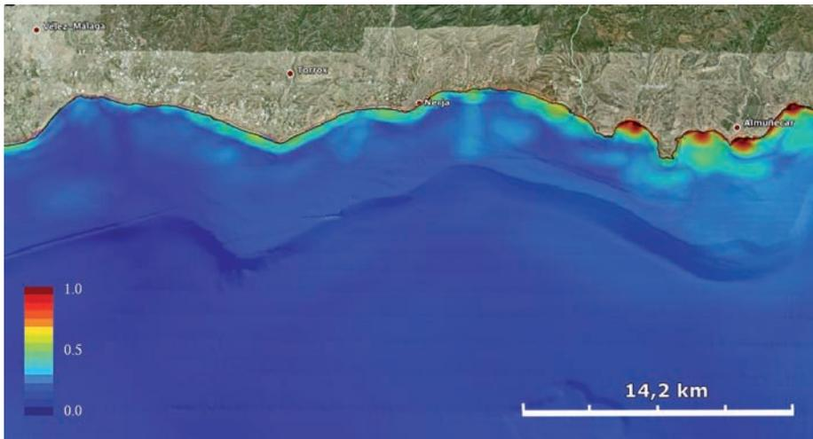
Figura 5.30. Representación de las amplitudes máximas en el sector de costa comprendido entre La Caleta y Almuñécar.
