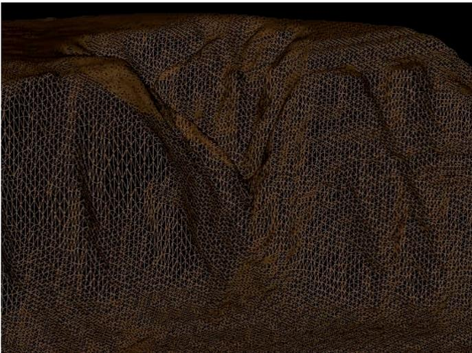
**Figura 4.16.** Ejemplo de malla para la zona de generación del deslizamiento.
