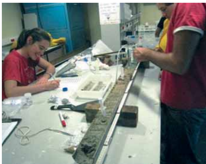
Figura 54. Muestreo testigo gravedad. (Autora Nieves López)
