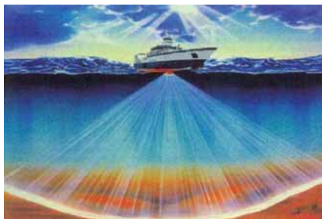
Figura 18. Esquema de funcionamiento de una ecosonda multihaz
