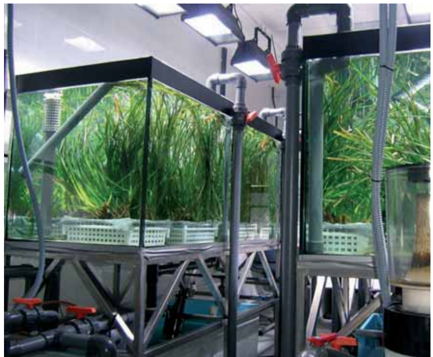
Figura 41. Dispositivo de mesocosmos de la Unidad de Experimentación Marina desarrollado en las instalaciones del Centro Oceanográfico de Murcia para el estudio de las respuestas fisiológicas de las angiospermas marinas Posidonia oceanica y Cymodocea nodosa al incremento de la salinidad del medio
