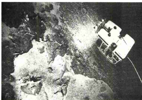
El ROV precisa de conexión a un barco para intercambiar datos.
